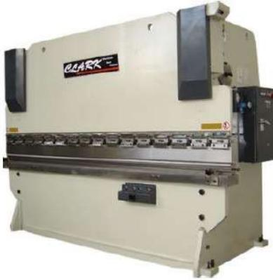
Figura 2.4 - Viradeira hidráulica.
