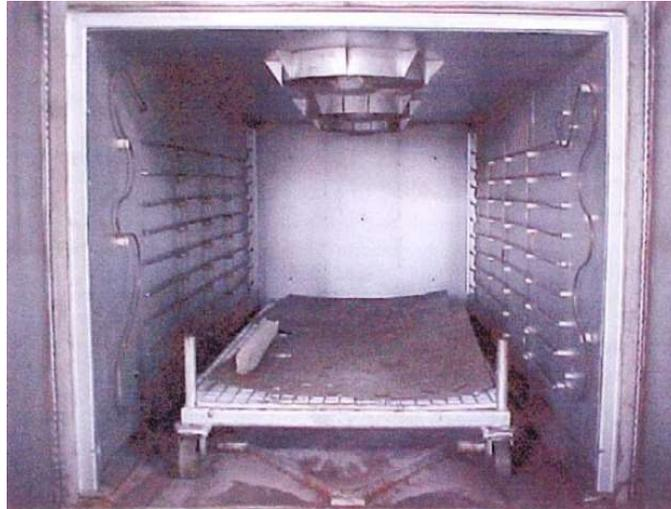
Figura 5.4 - Forno de ventilação forçada.
